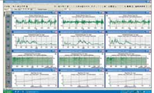
3軸測定は、時間波形、FFTスペクトル、フォータフオール、オーバーオールレベルのRPM変化を示す
