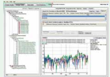
SPCのソフトウェアではデータ(右側)をソースパス レシーバモデル(左側)に、手動もしくはDOF情報を用いて自動でアサインします
