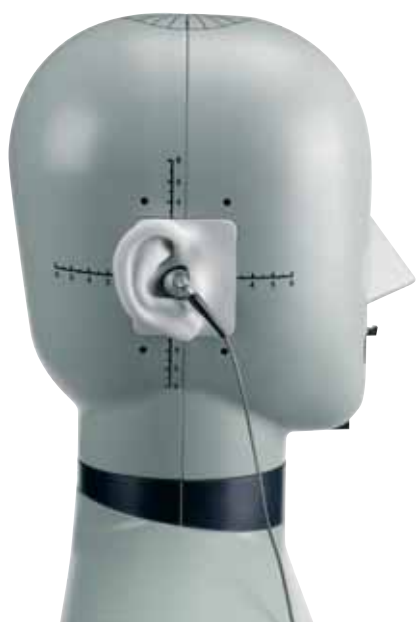
ヘッドトルソ シミュレータを用いたiPodの音圧レベル試験
